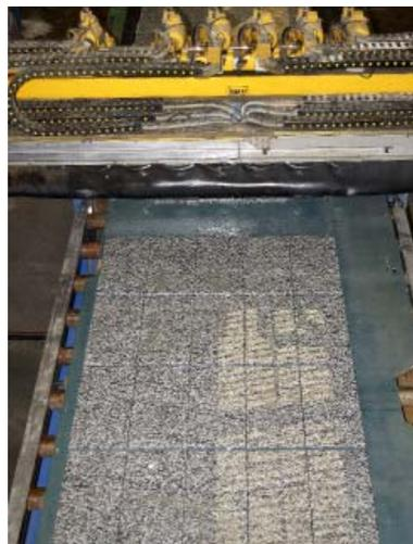
Corte de placas a partir de un tablero
